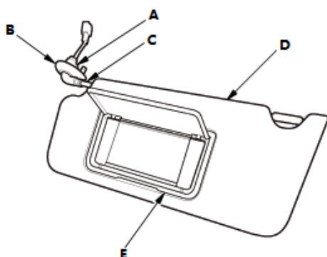
1. 如果侧窗帘式气囊已展开，更换遮阳板以及随侧窗帘式气囊展开列出的其他零部件。
