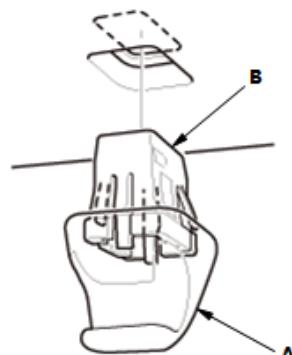
1. 顺时针旋转 45°，将固定器 (A) 安装到固定器密封圈 (B)。
