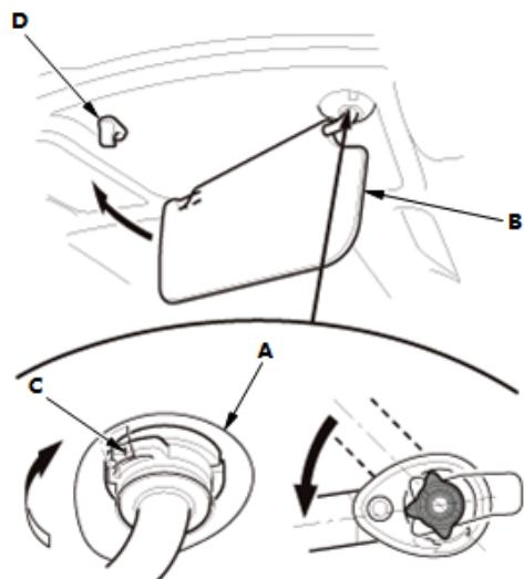
3. 在固定托架盖 (A) 时, 向前转动遮阳板 (B) 直到钩 (C) 卡入到位。
