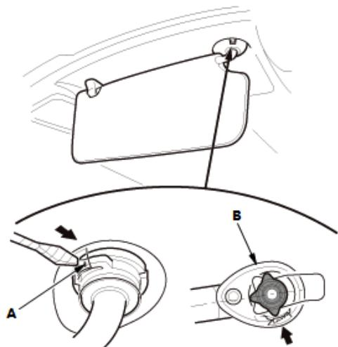
1. 使用一把平头螺丝刀，推动钩 (A) 穿过托架盖 (B) 的前侧的孔。
