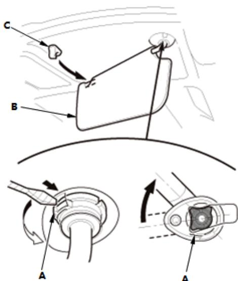
2. 用平头螺丝刀推入钩 (A) 时，将遮阳板 (B) 从固定器 (C) 上松开，并向后转动遮阳板 45°。
